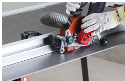
Прямолинейная резка с помощью УШМ
