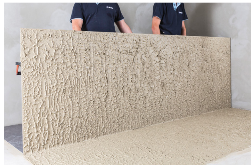
Выбор клея с хорошим смачиванием обратной стороны плитки
