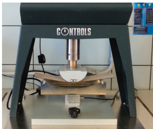
3. Разрушение опытного образца
