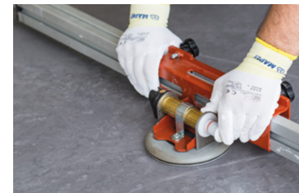
Использование присоски с насосом
